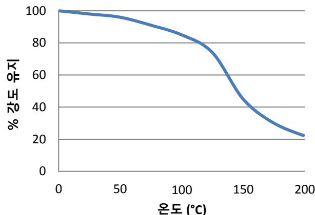
"고온 강도" 전단 강도 시험은 연강(*mild steel*)으로 진행되었습니다. 시편은 실온에서 완전히 경화 되었고 시험 전 30분 동안 실온에 놓아 두었습니다.
